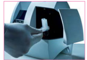
Kartusche im Analyzer platzieren Anzeige in ca. 3:50 Minuten
